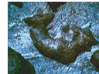
Détail de la corrosion au niveau d'une lettre de la légende sur un coin expérimental
