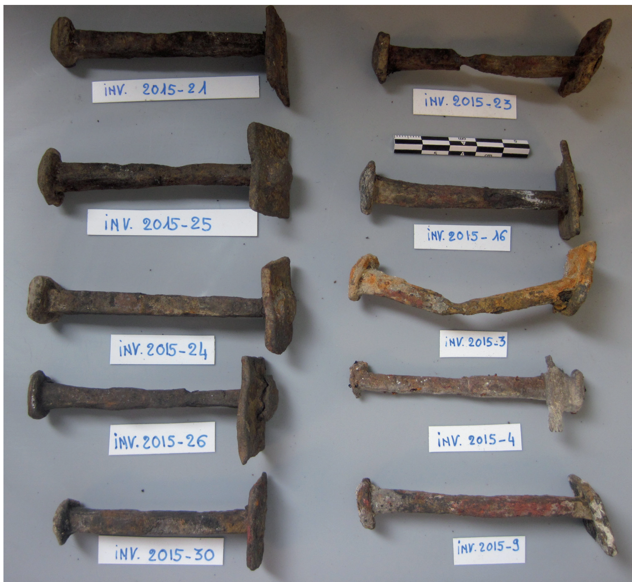
Fig. 34 - Échantillons de rivets d'assemblage des bordages à clin (Ph. V. SERNA, ministère de la Culture).
